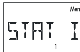
Fehlermeldung (bei Fehler inverse Umschaltung von 10 auf 0V)
