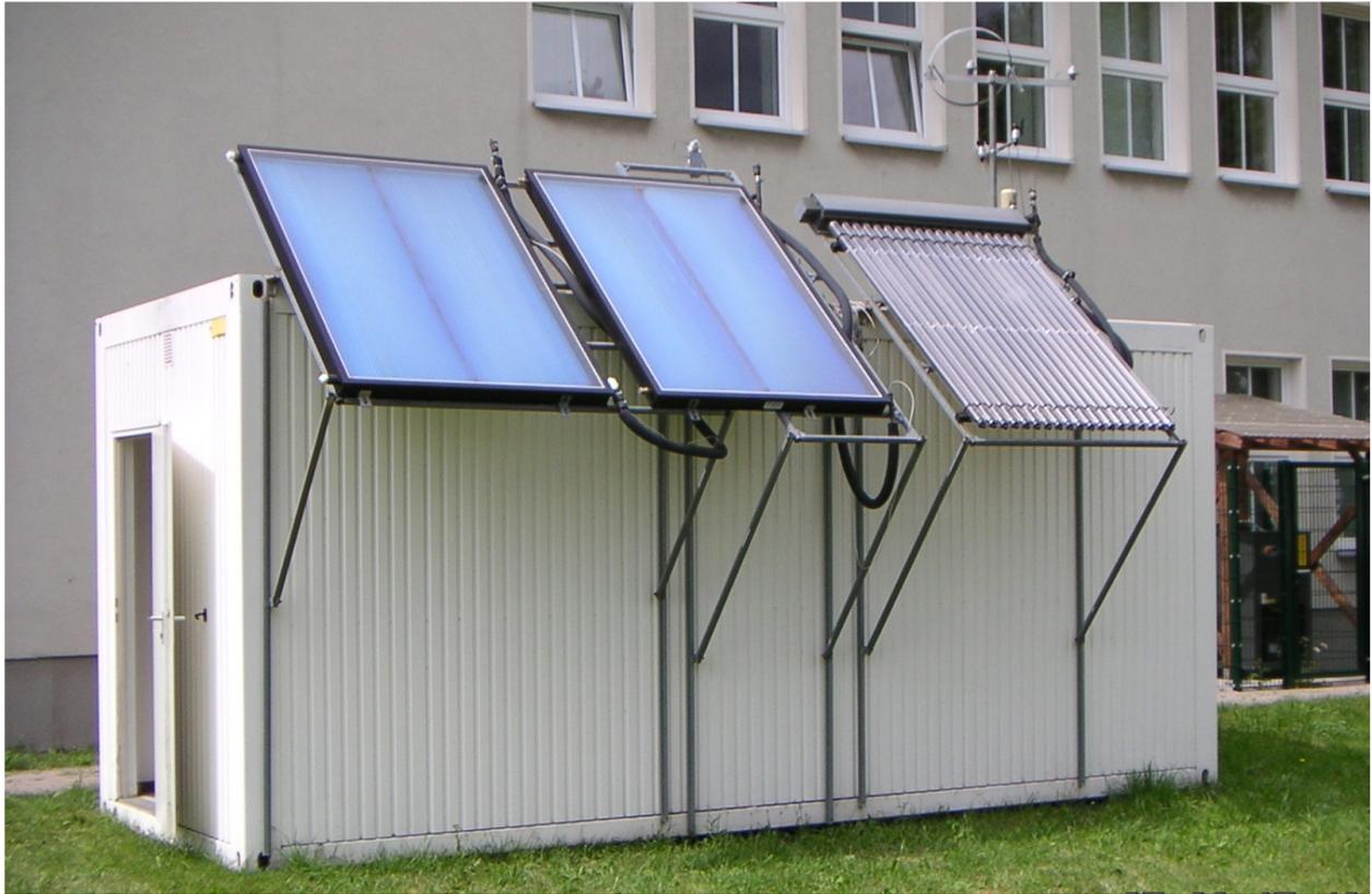
Test mit TS-K25-High-Flow-Solar-Kollektoren an der TU Ilmenau im Vergleich mit Röhrenkollektor ( Viessmann )
